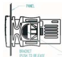
Los instrumentos deben ser montados en panel, en una perforación de 29x71 mm, y fijados usando las fijaciones que se acompañan.
